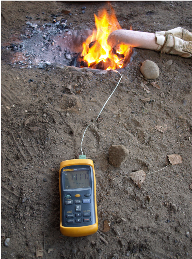
Experiment 1: Messung des Temperaturverlaufes bei der Bronzschmelze (© ExperimentA).
