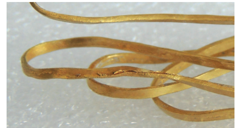
Abb. 297 Cham-Bachgraben. Golddraht. Sichtbare Überlagerungen treten an vielen Stellen des Golddrahtes auf. Sie stammen vom Ausschmieden. Ebenfalls erkennbar ist die leichte Wölbung der Schmalseiten nach aussen sowie ihre im Vergleich zur glatteren, breiteren Seite gröbere Körnigkeit. Beides entsteht durch die Deformation des Metallgitters beim Flachschiessen und belegt, dass der abschliessende Schmiedevorgang auf der breiten Seite erfolgte.
