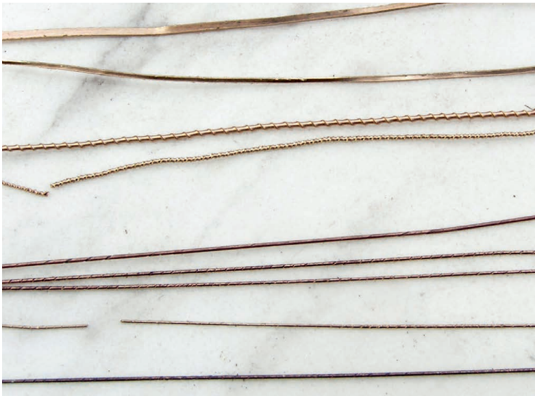
Abb. 429 Herstellungsetappen der Messingdrähte. M. 2:1.
