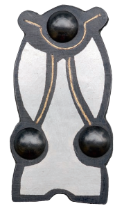
Abb. 445 Tiefschwarze Färbung durch Brünieren im Salzbad. M. 1:1.
