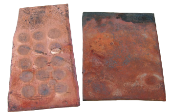
Abb. 446 Mit Alaun bestrichenes, geglühtes Eisen (rechts) wird in der Farbe geglühtem und abgeschrecktem Kupfer ähnlich (links). M. 1:1.
