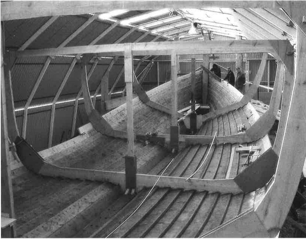
Abb. 1 Schalenbauweise bei der «Poeler Kogge» – der Replik des Poeler Wrackfundes von 1369. Foto Th. Förster, Wismar.
