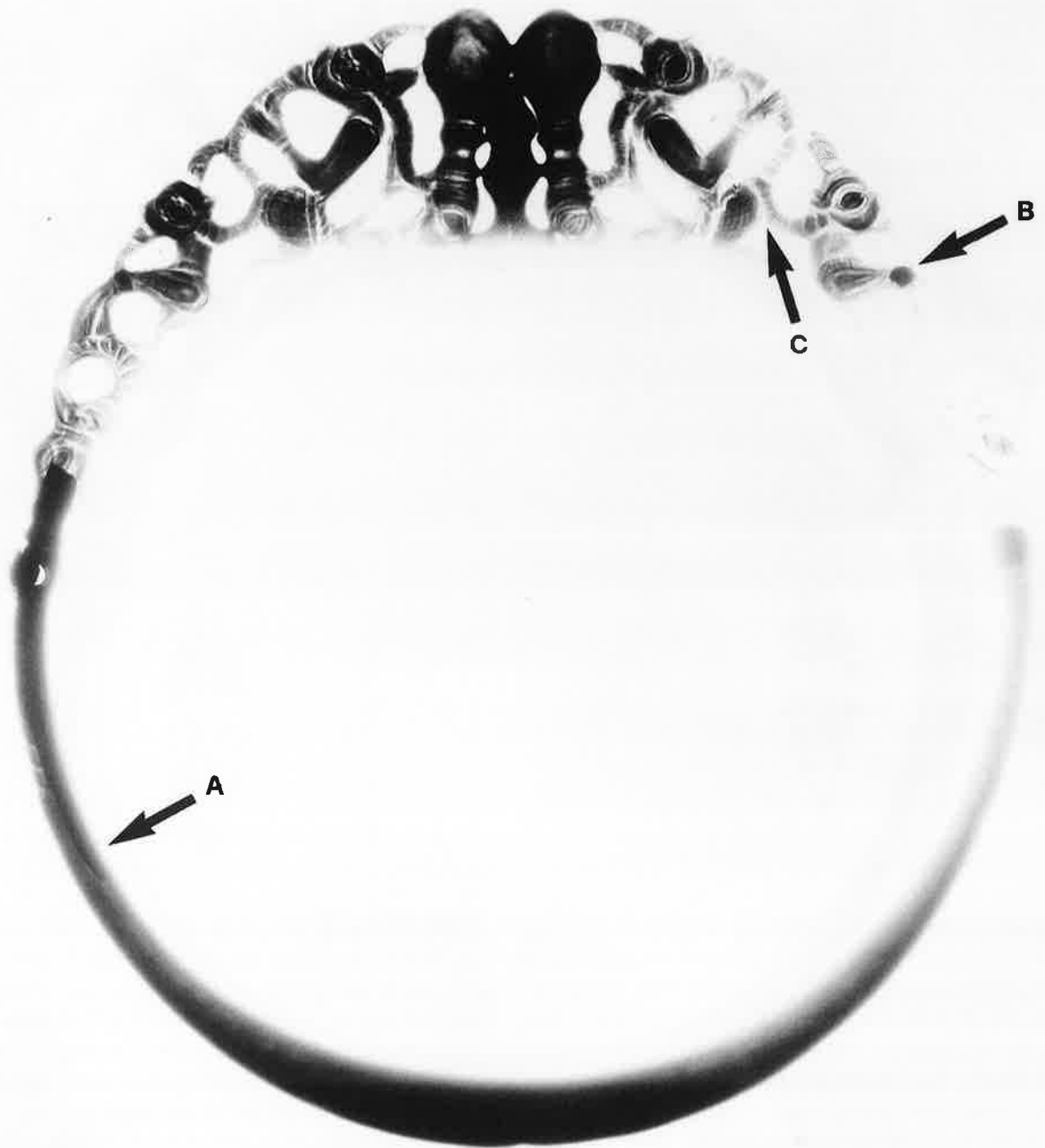
Abb. 22. Röntgenaufnahme des Halsrings E1. Pfeil A weist auf die Goldblecheinlage, Pfeil B auf den Metallkern im Innern des Schwanzknotens der «Sirene» C, Pfeil C auf eine Fügestelle zwischen den Figuren C und D. M 1:1.
