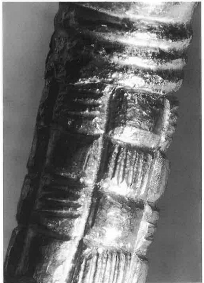
Abb. 98. Halsring E3. Fügestelle zwischen dem Zierfries und dem glatten Rückenteil des Rings. Die Oberfläche zeigt eine körnige Struktur, die auf den unsorgfältigen Auftrag des Lots und dessen Schmelzung zurückzuführen ist (Messstellen 7B und 8B).
