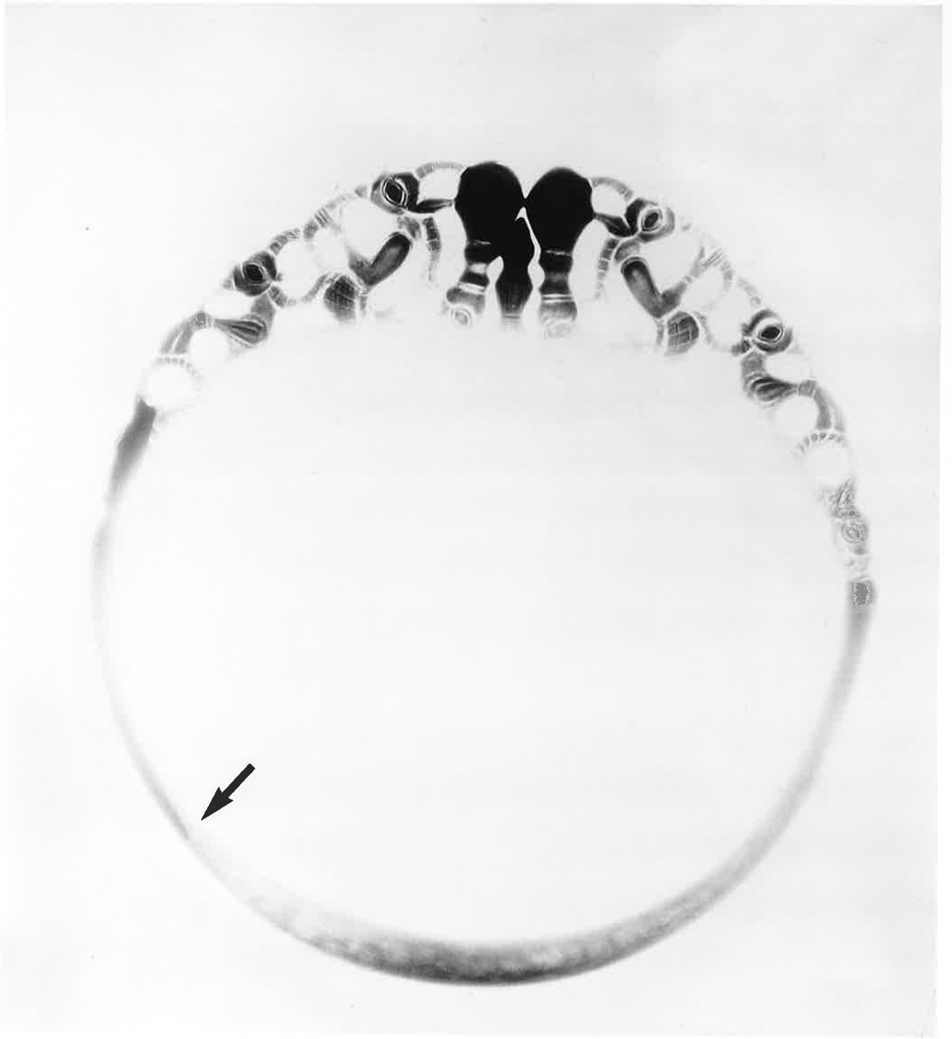
Abb. 32. Röntgenaufnahme des Halsrings E2. Der Pfeil weist auf die Goldblecheinlage. M 1:1.
