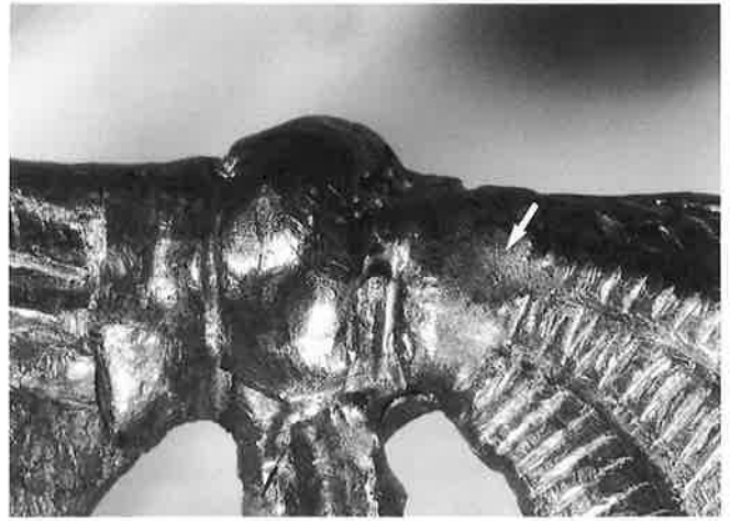
Abb. 95. Halsring E3, Seite A. Fügestelle im Bereich des Schwanzknotens des Vogels I. Hinter dem Knoten ist von bloßem Auge eine körnige Struktur zu erkennen, die auf einen thermischen Erwärmungsprozess an dieser Stelle deutet (Messstelle 11A).
