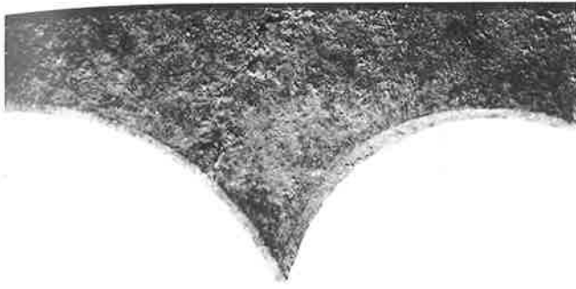
Abb. 23. Blech mit ausgestanzten Löchern (Nr. 2619). Länge des Bildausschnitts 26 mm.
