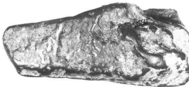
Abb. 27. Barren. Trennfläche Typ 2 (Nr. 3829). Länge des Bildausschnitts 33 mm.
