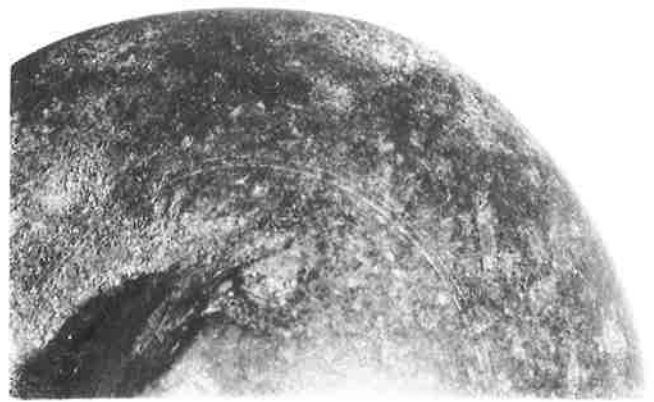
Abb. 37. Drehspuren auf Nagelkalotte Nr. 973. Länge des Bildausschnitts 25 mm.
