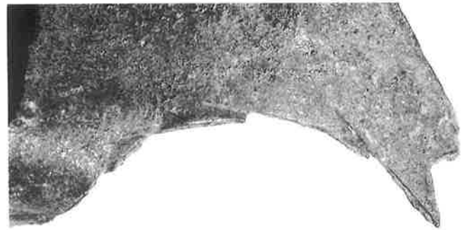
Abb. 24. Blech mit ausgeschrotetem Loch (Nr. 2631). Länge des Bildausschnitts 33 mm.
