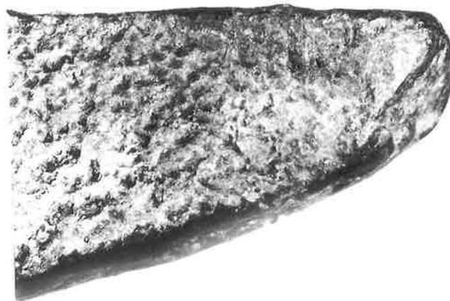
Abb. 28. Barren. Trennfläche Typ 3 (Nr. 3759). Länge des Bildausschnitts 32 mm.
