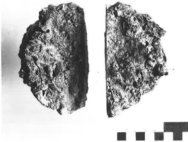
Abb. 126. Jeweils zur Hälfte geschnittene Schlackenkuchen der Proben 2/1985 (links) und 3/1985 (rechts). Oberseite. Deutlich erkennbar ist die konkave Einwölbung.
