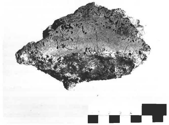
Abb. 127. Senkrechter Schnitt durch den geschichteten Schlackenkuchen der Probe 3/1985. Oberseite: Relikte von mm-grossen, angeschmolzenen Zuschlagstoffen. Blasenreiche Unterseite.
