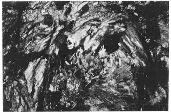
Abb. 59: Lavezgefäss (Fn 157), Dünnschliff. Grobschuppige Talkblätter vielfach radialstrahlig büschelartig, auch wirbelartig aggregiert. Talk zum Teil mit (wenig) Chloritblättern verwachsen. Daneben auch Partien mit feinschuppigem Talk. Karbonat im Korn stark granoplastisch. Reinere Karbonatpartien wechseln mit Karbonat-Talkverwachsungen und reineren Talkpartien. Viel mehr Magnetit als in den andern, hier meist nicht mit Chlorit durchsetzt, sondern eher innerhalb von Karbonatpartien. Lockere bis enggepackte Magnetitflecken, auch gestreckte Gebilde. 90x. Mengenverhältnis im Schliff je 40-45% Talk und Karbonat. 5-10% Chlorit, 5-8% Magnetit.
