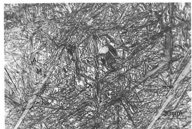
Abb. 68. Ausschnitt aus dem Martensit-Gefüge der Abb. 67. Zwischen den Martensitnadeln (M) liegen Austenit-Resten (A).
