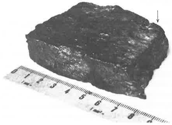
Abb. 65. Der Stahlblock vom Welschdörfli (vgl. Taf. 60, 16). Pfeil = Lage des Schliffes. 488 Gramm: Grösse 80×58×19 mm.
