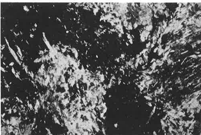
Abb. 56: Partie im gleichen Schliff mit grossen Aggregaten von vorwiegend dunkel erscheinendem Chlorit. Daneben talkreiche und gemischte Partien. Rechts oben etwas Karbonat. 90x.
