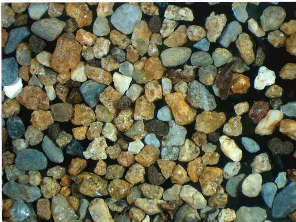
Abb. 85 Loppburg 2001. Siebrückstand der Sandschicht, Probe P3, Kornfraktion 0,5–1 mm. Eckige kristalline Komponenten, gut gerundete, grau-blaue Kalke und einige, durch Wellenschlag polierte Körner als Hinweis auf eine lokale Herkunft (Uferbereich). Sehr ähnliche petrographische Zusammensetzung wie der Mörtel-sand in Probe P5. Bildbreite 14,3 mm. Foto C. Pümpin.
