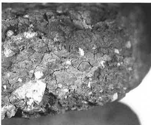
Abb. 94 Loppburg 2001. Keramikgruppe Id, Inv.-Nr. 10/13/356.3. Makroskopische Aufnahme einer Bruchfläche mit toniger, zu Rissen neigender Matrix. Bildbreite 14,3 mm.
