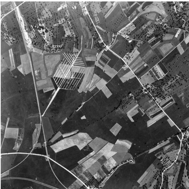
Abb. 9 Meliorationswerk Steinhausen-Sennweid. Flugaufnahme des Drainagenetzes vom 24. Juni 1942. Reproduziert mit Bewilligung von swisstopo (BA057554).
