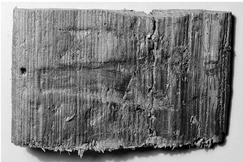
Abb. 163 Steinhausen-Chollerpark, OS. Deutliche, nicht durch Einlagerung entstandene Druckstelle auf einer Schindel.
