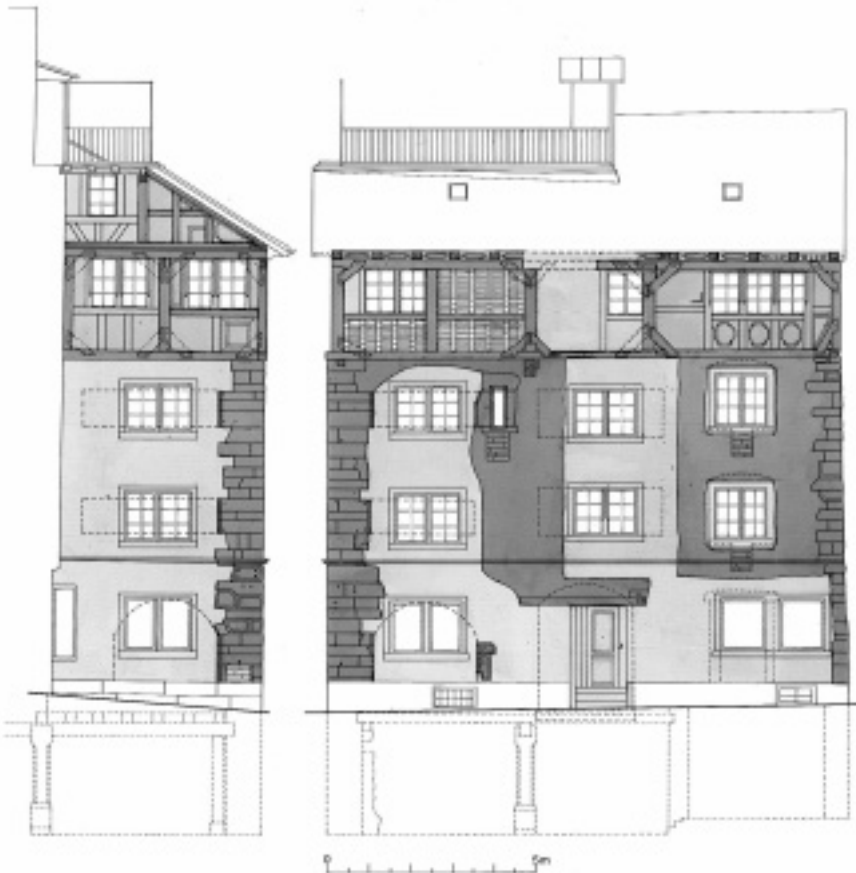
Abb. 17. Zürich-Augustinergasse 14, «Kante». Nord- und Westfassade mit baugeschichtlichen Befunden (dunkler Raster: älteste Bauteile). Rechts das Haus in der Darstellung von Jos Murer 1576. Zeichnung Stadtarchäologie Zürich, A. Engelhard.
