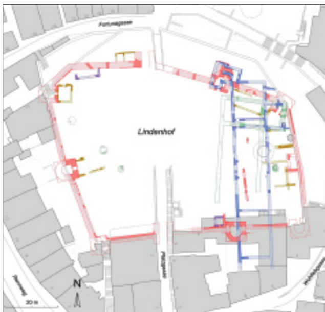
Abb. 1. Zürich, Lindenhof. Die wichtigsten Steinbauphasen. In und auf den Mauern des spätrömischen Kastells (rot) entstand in karolingischer Zeit ein erstes Pfalzgebäude (grün). Es wurde im frühen 11. Jh. durch einen grosszügigeren Komplex der salischen Königspfalz ersetzt (blau). Weiter sind Mauerzüge aus römischer (violett) und frühmittelalterlicher Zeit (gelb) dargestellt. Plan Stadtarchäologie Zürich, U. Jäggin.
