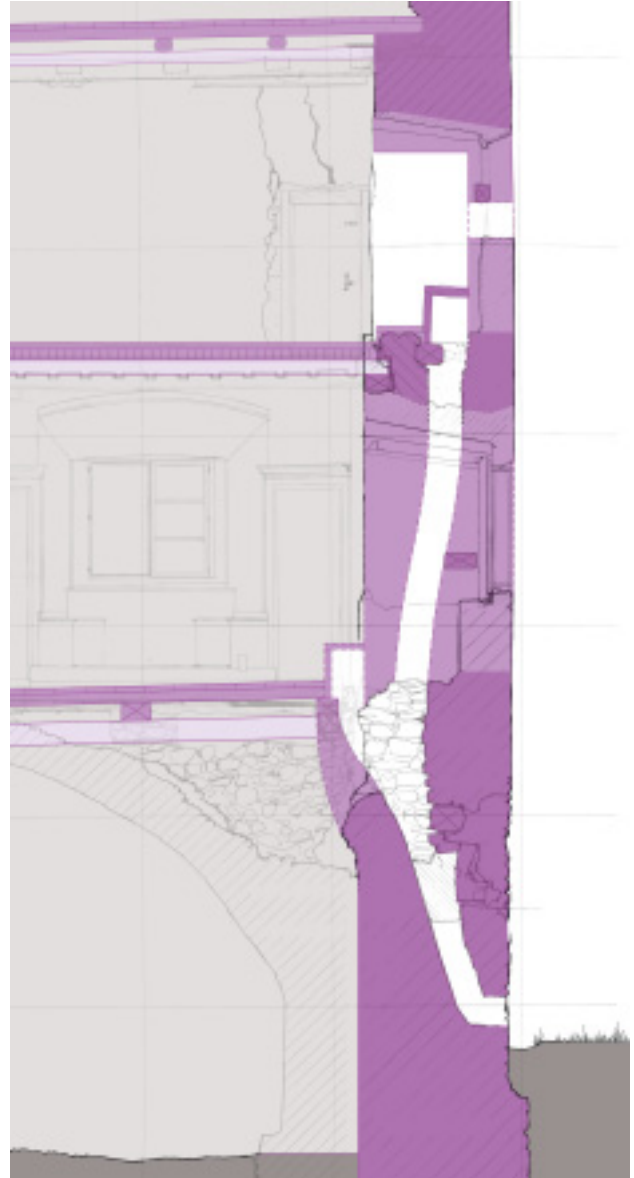
Abb. 21. Müstair, Kloster St. Johann, Plantaturm. Ehemaliger Abortschacht, vom Abort im 2. Obergeschoss, mit Zubringer im 1. Obergeschoss und Entleerung knapp über dem damaligen Aussenniveau. Schnitt gegen Westen. Plan AD GR, Bauhütte Müstair.
