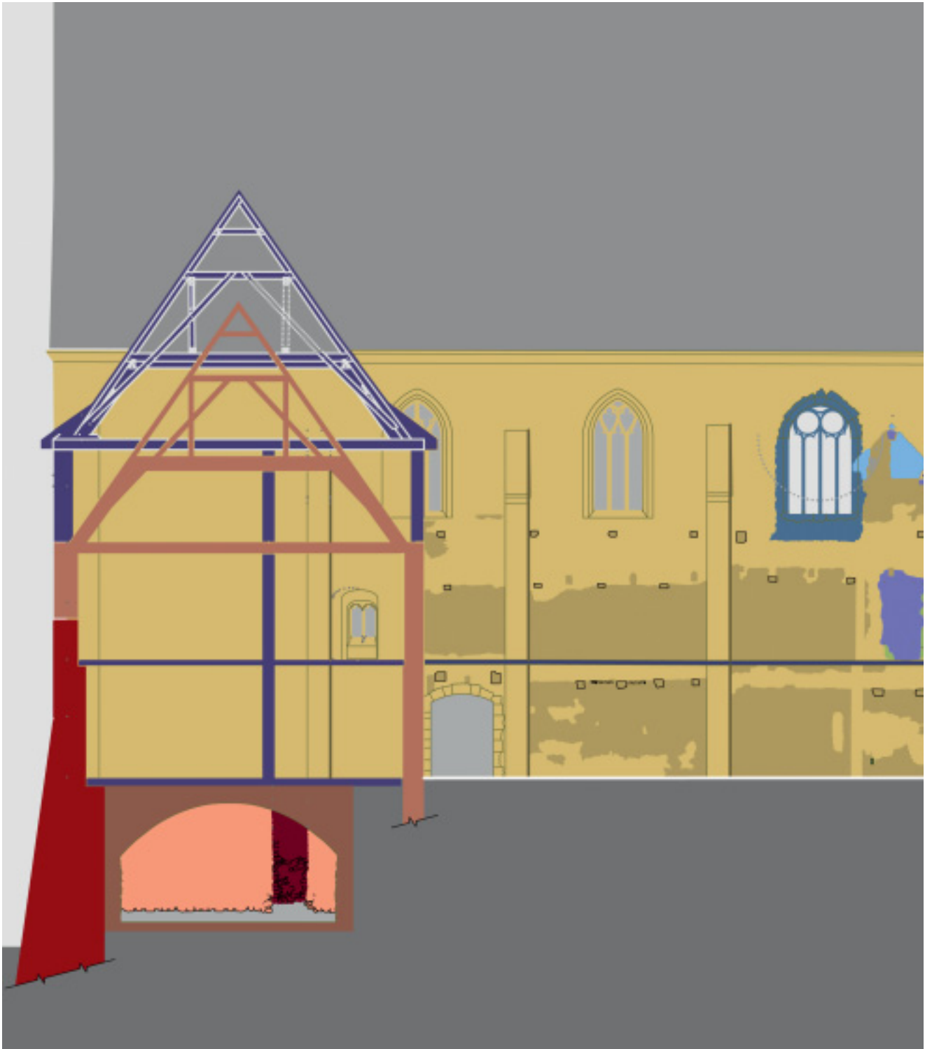
Abb. 20. Basel, Im Lohnhof 3–9/Kohlenberg 20, «Lohnhof». Gewölbekeller unter dem so genannten Armarium (Bibliothek) des Leonhardsstifts (Gebäudeprofil im Schnitt). Der tonnengewölbte Raum liegt unmittelbar innerhalb der Inneren Stadtmauer (links unten). Er entstand im 13. Jh. und bedingte den Abbruch der Burkhardtschen Stadtmauer im Längsbereich dieses Kellers (dunkelrot). Im Hintergrund die Südfassade der Hallenkirche von 1490. Zeichnung Basler Denkmalpflege.
