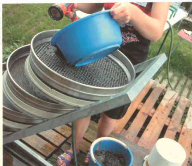
Fig. 13 Tamisage des échantillons de sédiments à l'aide de tamis de plus en plus fins. Decantazione di un campione con setacci a maglie di larghezza diversa. Photo S. Jacomet.
